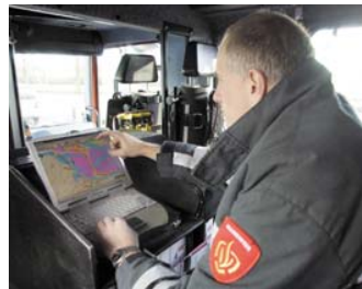
Figuur 7 CRP interface. De brandweer kan onderweg naar de locatie al inzicht krijgen in de actuele voorraad gevaarlijke stoffen [1] .
