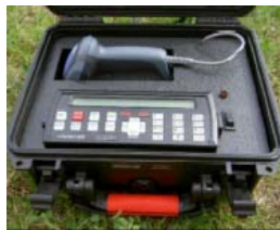
Figuur 8 Datatrak-AGR systeem in koffer model (kan ook ingebouwd worden). Bestaande uit een scanner en een data invoer module met ingebouwde GPS.
