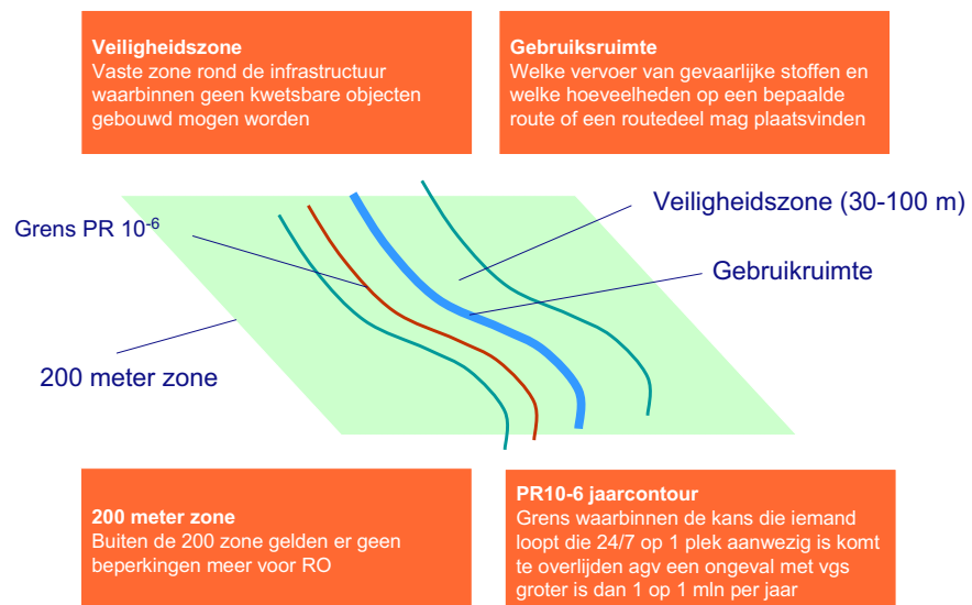
Figuur 3 Overzicht gebruiksruimte, veiligheidszone en PR-contouren
