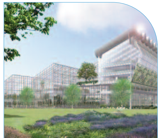
Afb. 18b: Ontwerp voor een kas/kantoorgebouw 'Villa Flora' op de Floriade 2012 in regio Venlo. Het gebouw zal energetisch zelfvoorzienend zijn. De bouwkundige constructie is zodanig gedetailleerd dat het betonskelet en de vloeren demontabel zijn. In het gebouw kan ook groente verbouwd worden.
