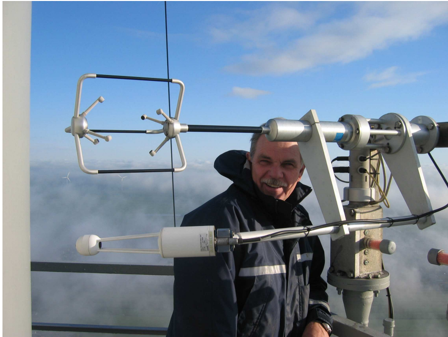
(a) Sonische anemometer weghalen van de Cabauw meetmast voor metingen in de KNMI klimaatkamer.
