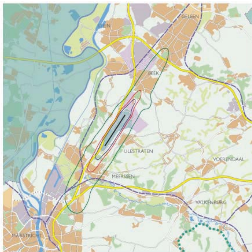
figuur 4.2 Luchthaven Maastricht Ke contouren referentiesituatie (variant met meteo-marge) schaal 1:150.000
