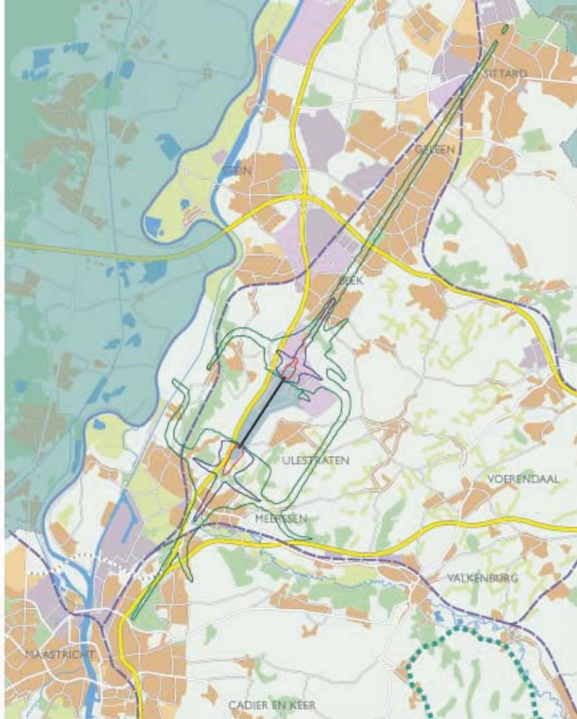
figuur 4.23 Luchthaven Maastricht Individueel-risico-contouren exploitantalternatief schaal 1:150.000
