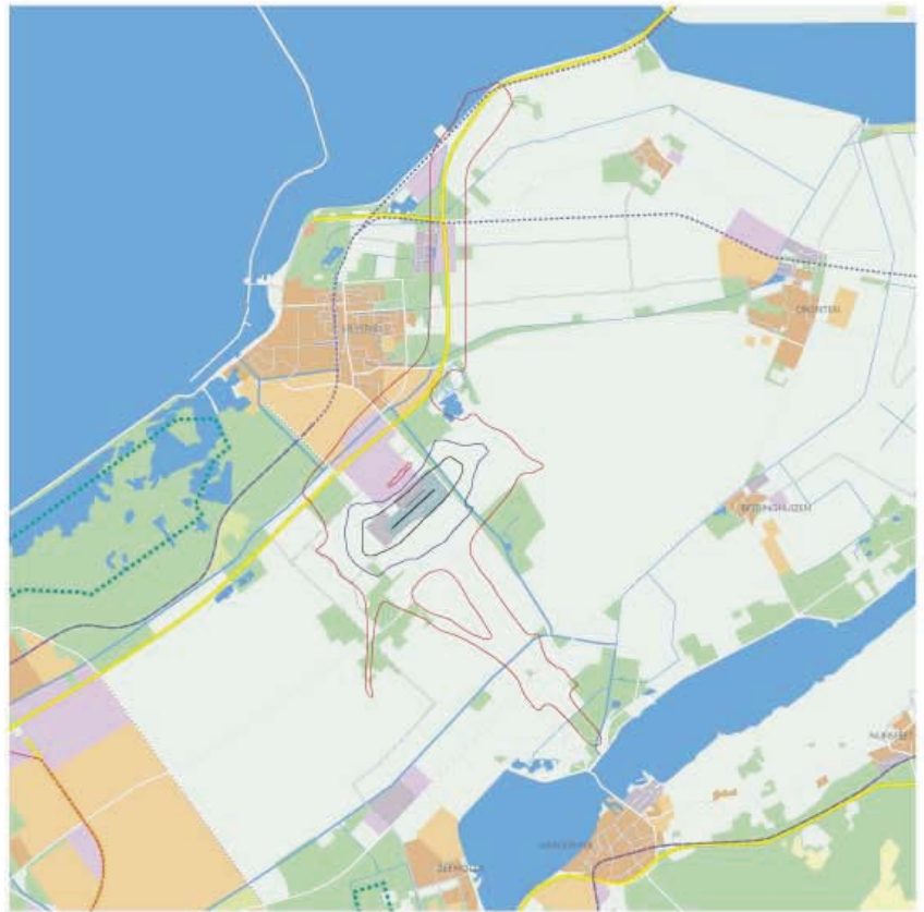
figuur 4.13 Luchthaven Lelystad Bkl-contouren (omhullende) exploitantalternatief (2100 meter baan/ 900 meter parallelle baan) schaal 1:300.000
