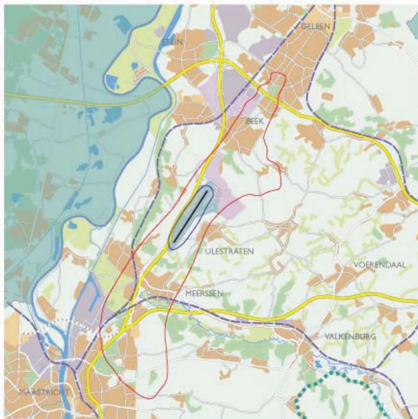
figuur 4.16 Luchthaven Maastricht 50 Lden-contour exploitantalternatief voor de grote luchtvaart en de kleine luchtvaart schaal 1:150.000
