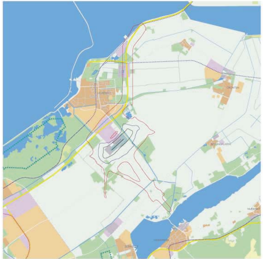
figuur 4.11 Luchthaven Lelystad Bkl-contouren (omhullende) 1800 meter baan/ 700 meter parallelle baan schaal 1:300.000
