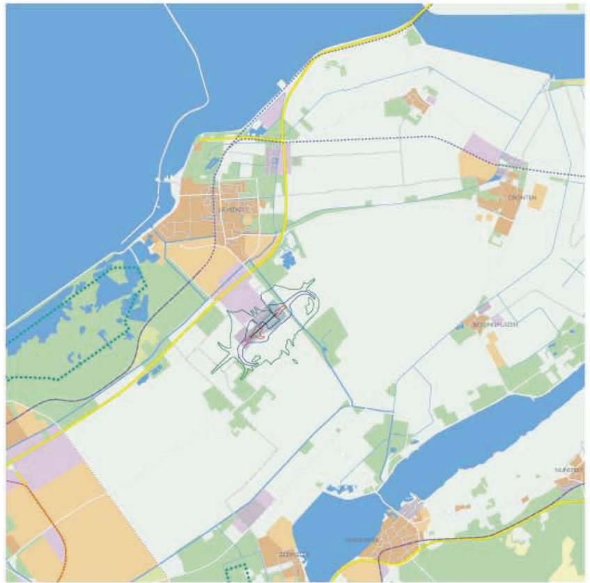
figuur 4.26 Luchthaven Lelystad individueel-risico-contouren jaarberekening 2000 schaal 1:300.000
