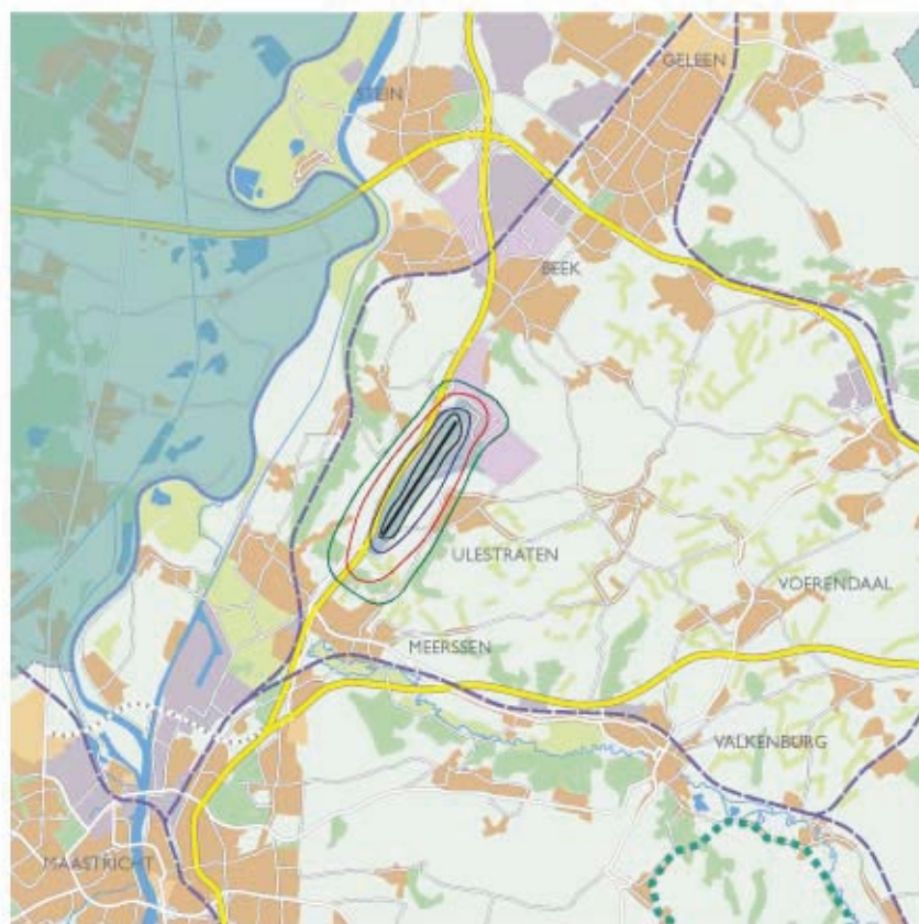
figuur 4.7 Luchthaven Maastricht Bkl-contouren referentiesituatie (variant met meteo-marge) schaal 1:150.000
