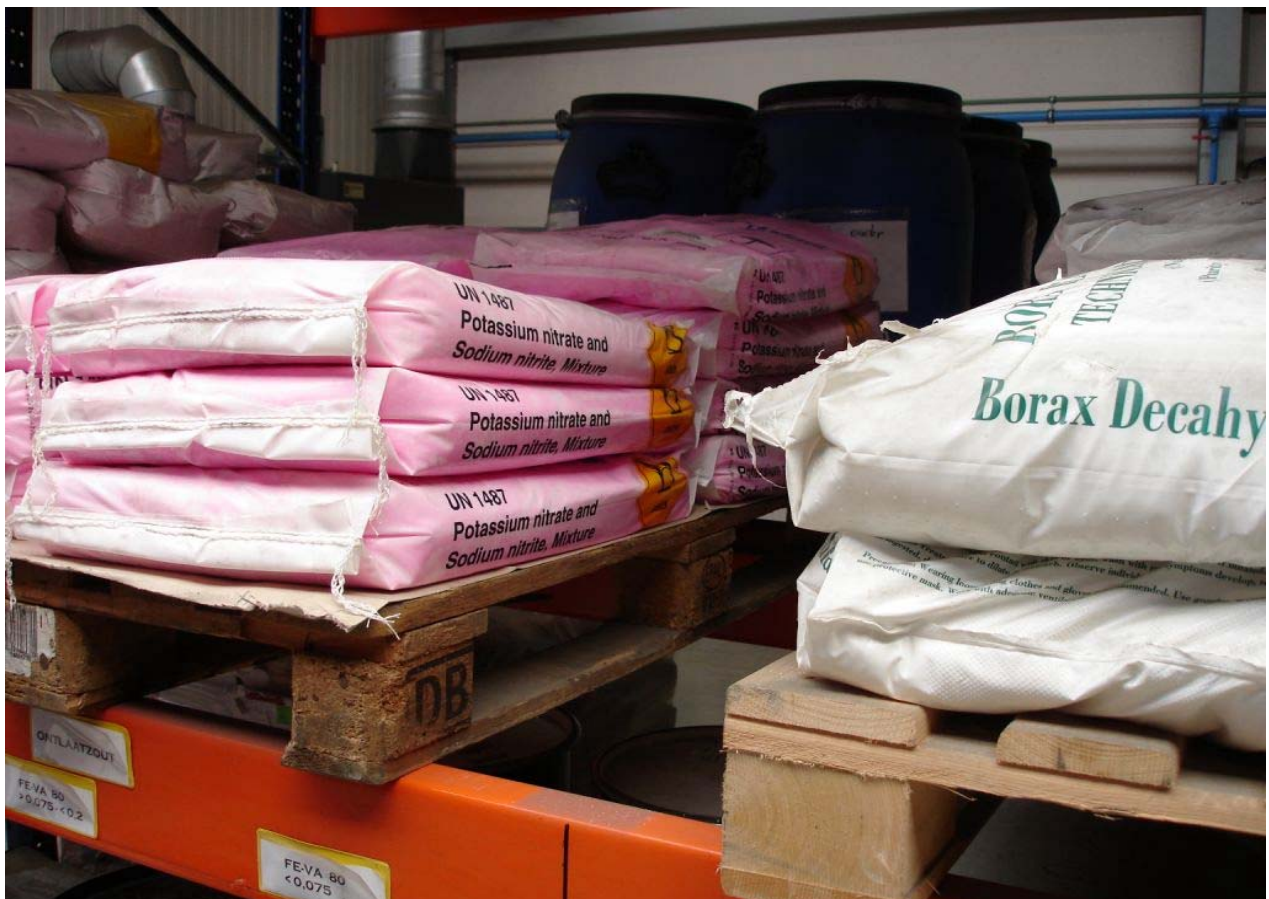
Figuur 1: opslag van gevaarlijke stoffen in een magazijn in plaats van in een opslagvoorziening voor gevaarlijke stoffen.
