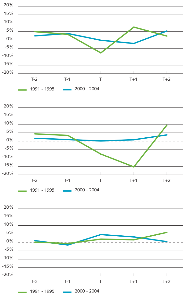
Figuur 5.3 Ontwikkeling automobilititeit woon-werk, zakelijk en overige motieven tijdens verschillende recessieperiodes in voertuigkilometers, procentuele veranderingen ten opzichte van het voorgaande jaar Bron: OVG/MON
