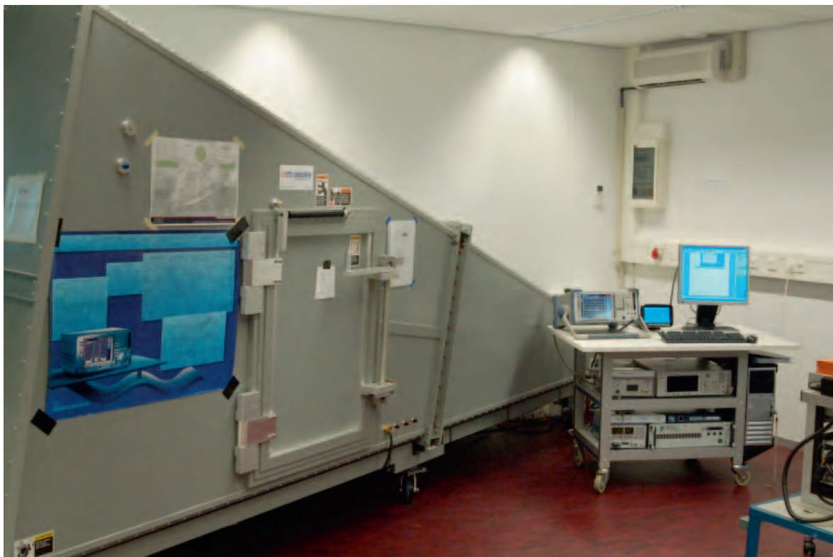
Figuur 3. Meetopstelling immuniteit; GTEM (Gigahertz Transverse Electromagnetic Cell)
