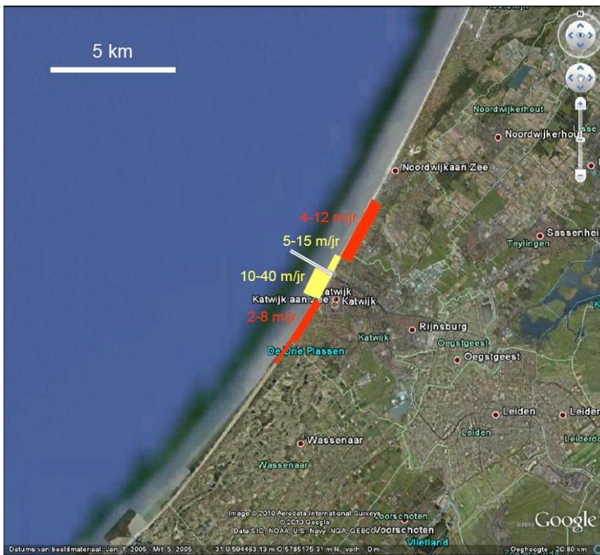
Figuur 5.2 Schets van geschatte grootschalige effecten van 2 km lange dammen – initieel (eerste paar jaar) – geel geeft aanzandende zones aan, rood eroderende zones – niet op schaal
