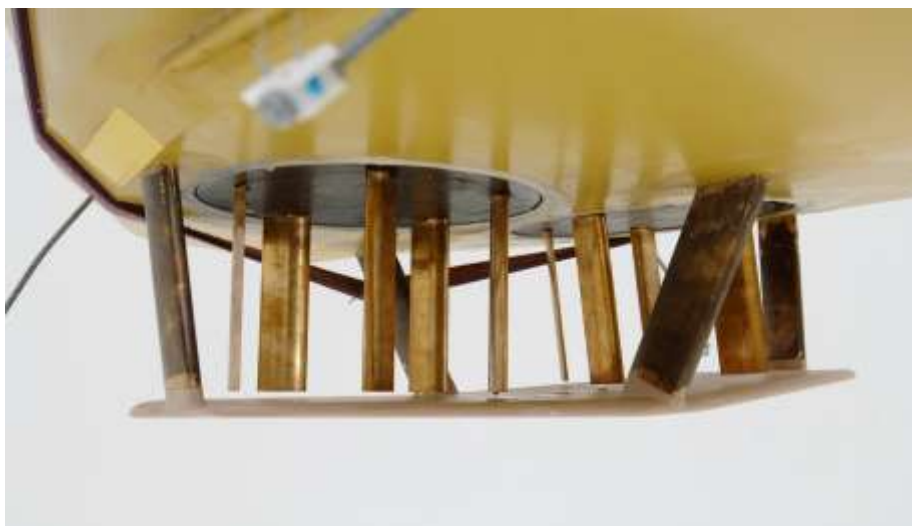
Figure 26: Voith Schneider propulsors
