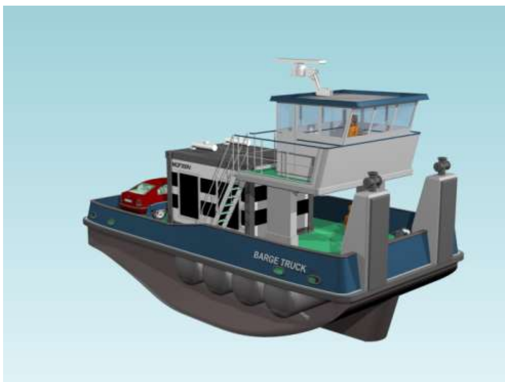
Barge Truck met gas-generatorset aan dek en LNG opslag benedendeks
