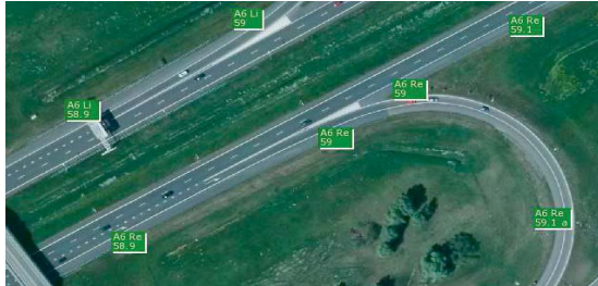
Afbeelding van het puntstuk, duidelijk is te zien dat het puntstuk rechts kleiner is dan het puntstuk links.
