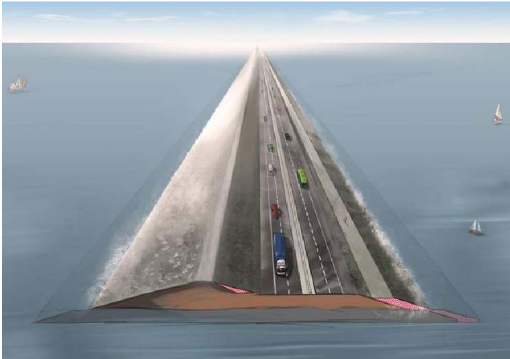
Figuur 2.5: Referentieontwerp dijkversterking Afsluitdijk
