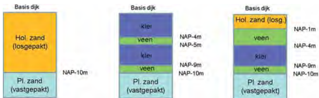
Figuur 4.11 Doorgerekende varianten in grondopbouw primaire keringen
