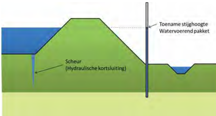
Figuur 3.13 Toename stijghoogte (waterspanningen) als gevolg van hydraulische kortsluiting
