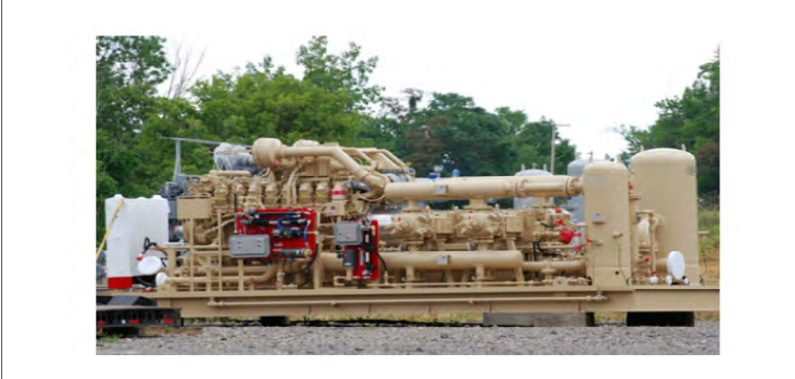
Afbeelding 2.9. Compressor op skid [ref. 2.]
