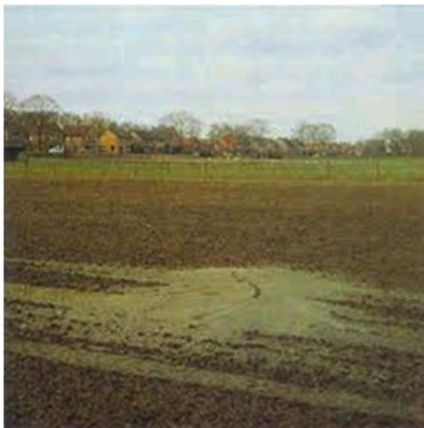
Figuur 6.2 Mogelijk effect in geval van verweking opgetreden in Roermond 1992 (bron: Drs. G. Houtgast/KNMI via kennislink.nl)
