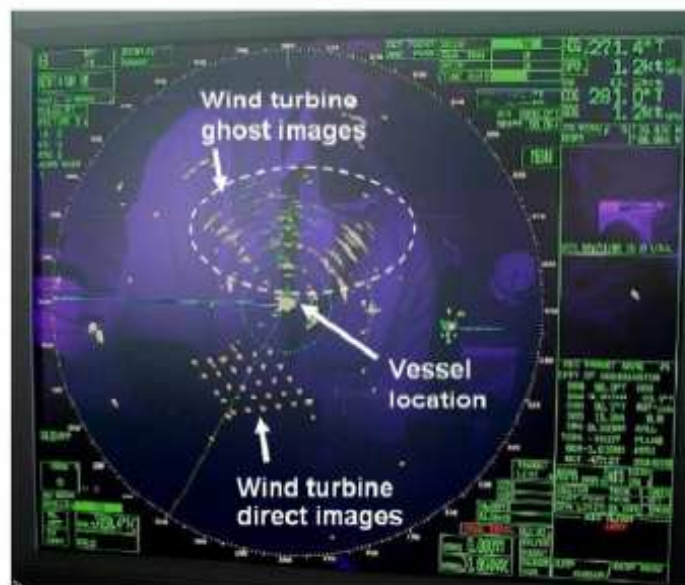
Figuur 45c. Beeld van het East Anglia One windpark met één schip (midden) en reflecties van een mast
