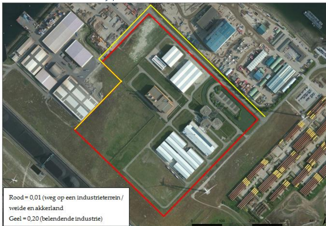
Afbeelding 24: Overzicht van de ABC correctiefactoren voor directe straling zoals die worden toegepast op en rond de terreingrens van COVRA.
