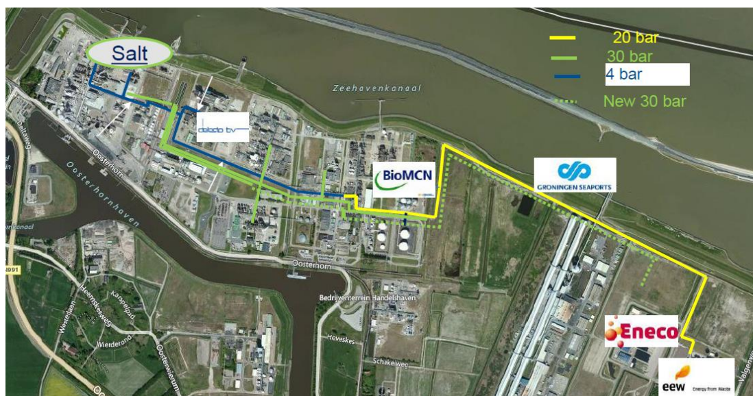
Figuur 6. Stoomnet op het Chemiepark.
