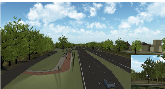
Figuur 11 Aanzicht van de zuidelijke hellingbaan naar de fietstunnel
