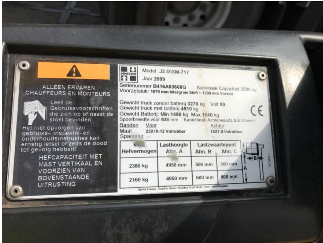
Foto 7 Lastdiagram vermeld op heftruck.
