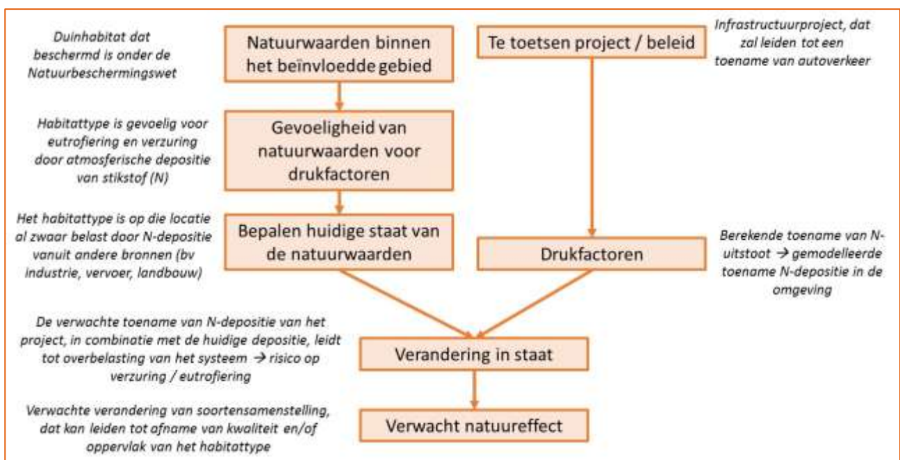
Figuur 5 Stappenschema voor het bepalen van fysieke natuureffecten als gevolg van verandering in drukfactoren, zoals toegepast in milieueffectrapportage (m.e.r.). 15
