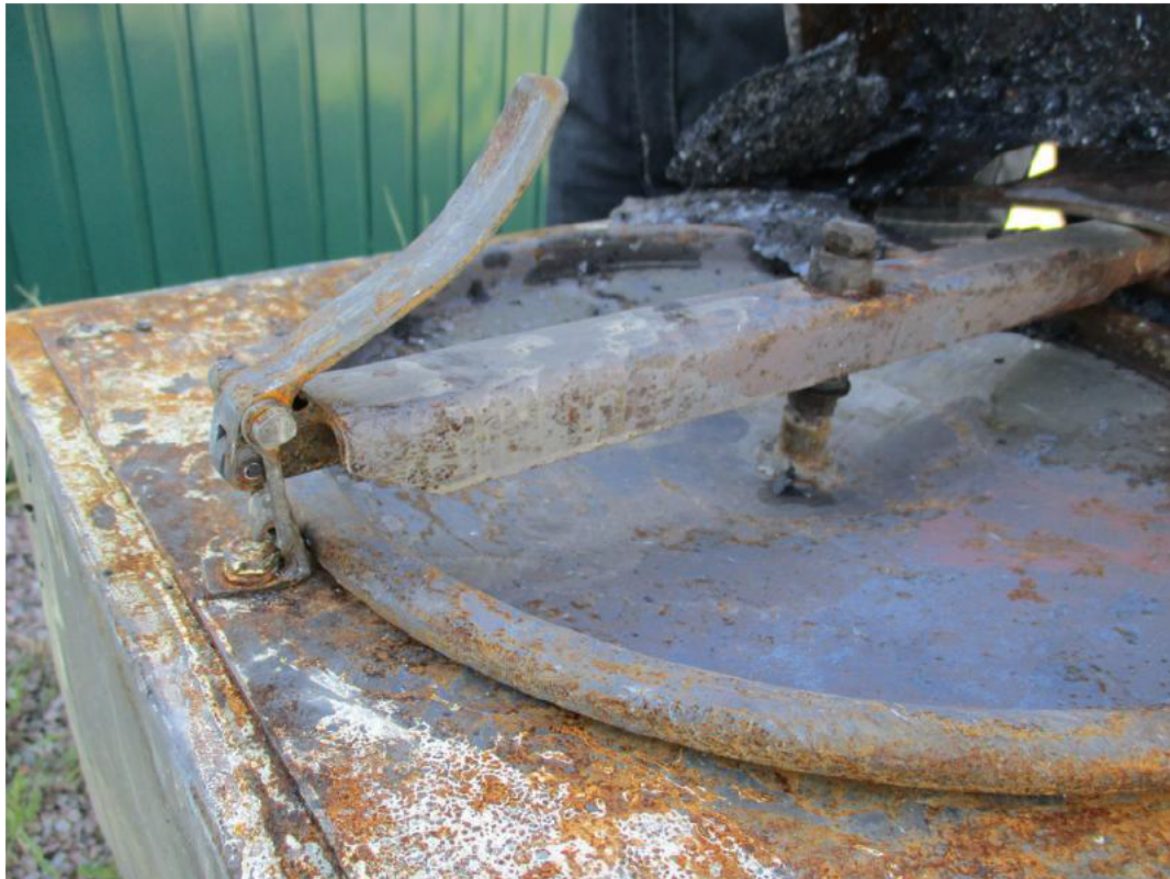
Foto 14 Afsluitbare binnen deksel met klem mechaniek van het regenerereer apparaat
