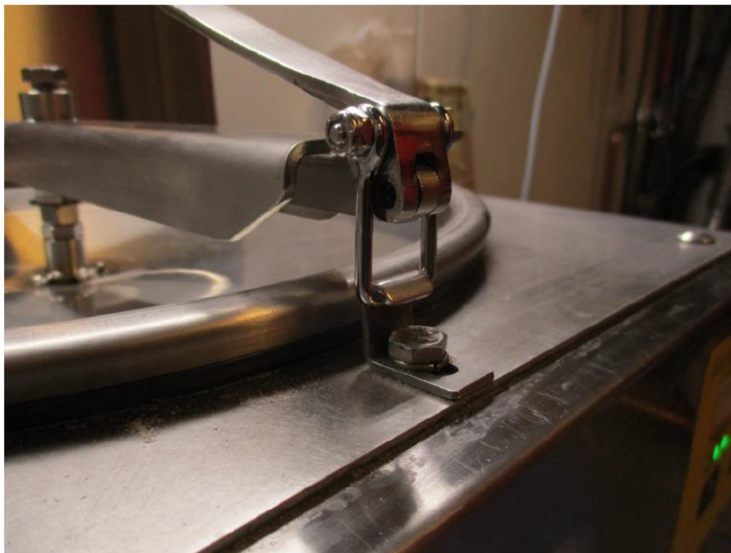
Foto 31 Afsluitmechaniek (handel en klemconstructie) van de afsluitbare reservoirdeksel
