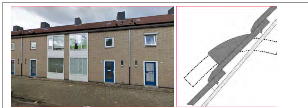
Figuur 7. Dakdoorvoer rijtjeswoning
