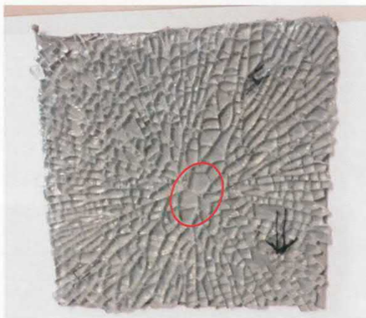
Figuur 5.4: Ruit 4. Vlinderpatroon centraal in het monster
