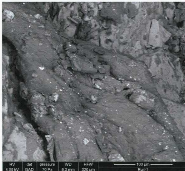
Figuur 5.11: Ruit 1. SEM opname verondersteld insluitel; in werkelijkheid een schimmel
