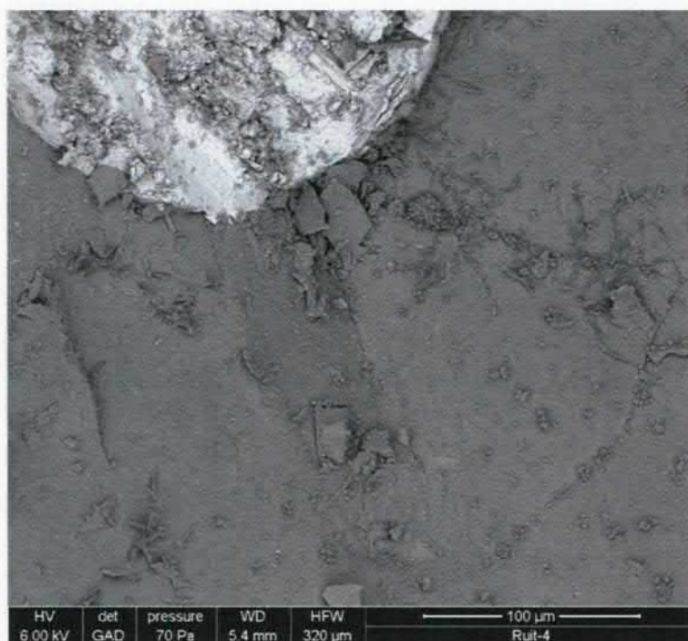
Figuur 5.14: Ruit 4. SEM opname van radiale barsten in het glas rond het NiS insluitel. Het vertakte object rechts van het insluitel is een schimmel. Talrijke fijne deeltjes op het breukvlak
