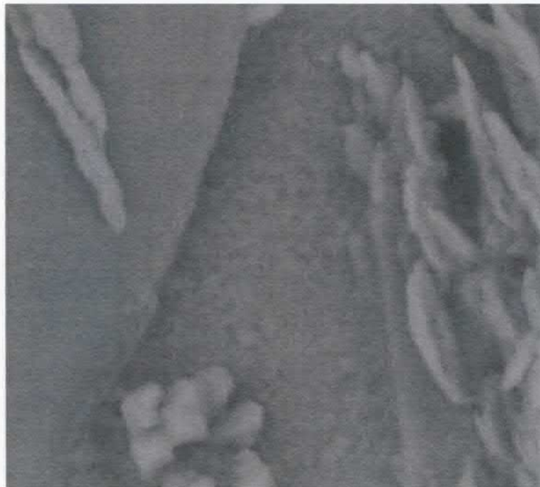
Figuur 5.18: Ruit 4. Uitsnede uit de SEM opname in figuur 5.17. Sponzige structuur van het glas in het midden van de foto
