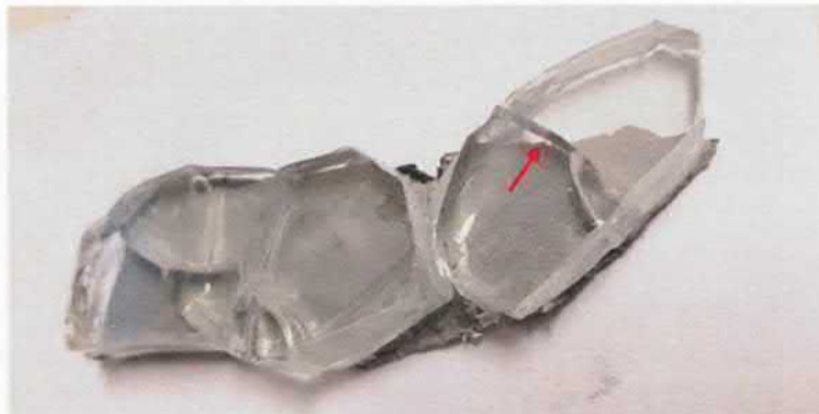
Figuur 5.5: Ruit 4. Vlinderpatroon; de rode pijl geeft het breukvlak met insluitel aan
