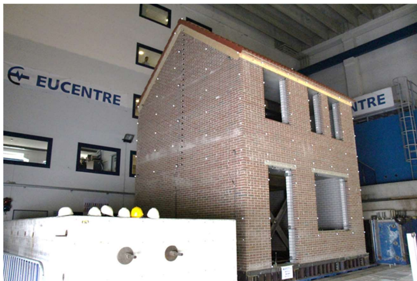
Figuur 7 Trillings-test van een metselwerk gebouw (schaal 1:1)
