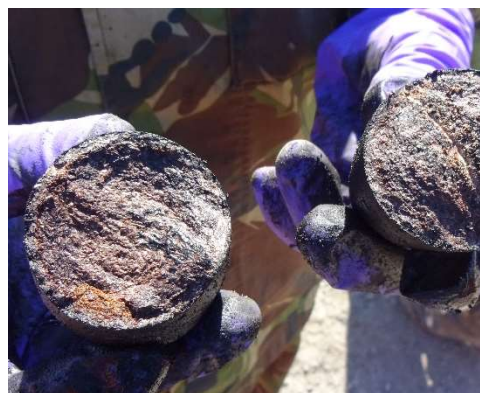
Figuur 64 Opengebroke hoofdlading van één van de 60 mm mortiergranaten. Metalen wand is volledig doorgeroest.
