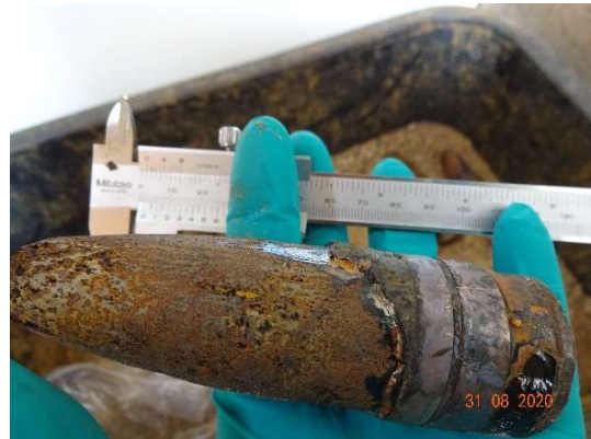
Figuur 31 Corrosie rond geleideband.
