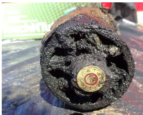
Figuur 63 Eén van de 60 mm M49A2 brisantgranaten in verpakking met slaghoedje en grondkardoes zichtbaar.
