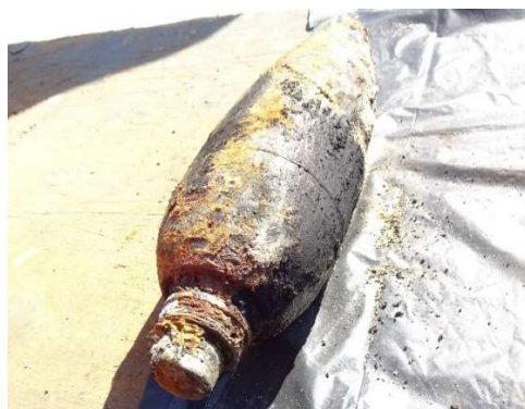
Figuur 66 M16, 3 inch springrook mortiergranaat na schoonmaken.
