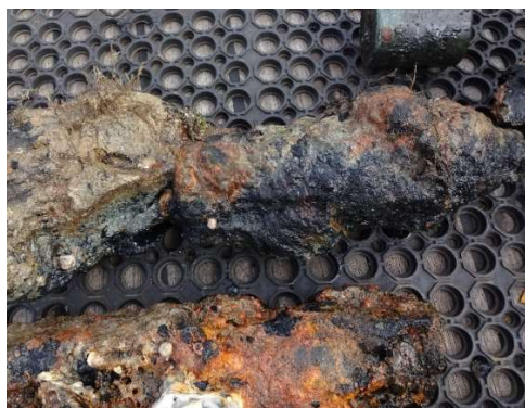
Figuur 65 3 inch springrook mortiergranaat met flinke aangroei direct na berging.
