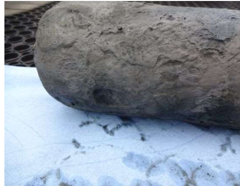
Figuur 52 Holte in omhulsel van 4,2" springrook mortiergranaat (M8).
