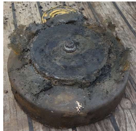
Figuur 15 M1, nr 25 Nederlandse AT schotelmijn hoofdloading met dunne restanten van het omhulsel.
