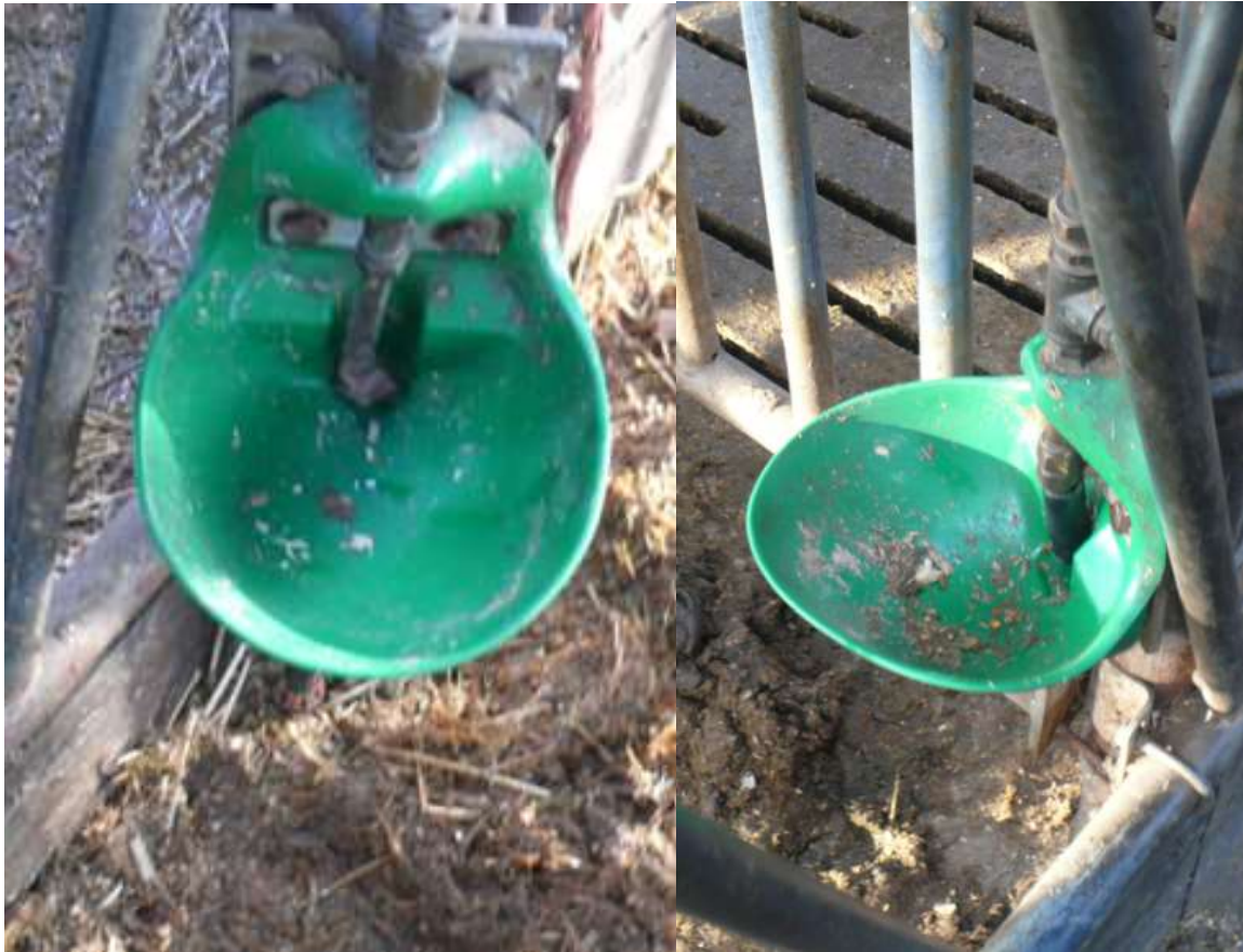
Stal 2. Kapotte waterbakjes en geen waterdruk in de leidingen.
