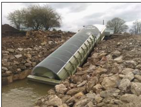
Figuur 4: de vijzel van Landustrie Sneek in het Wilhelminakanaal
