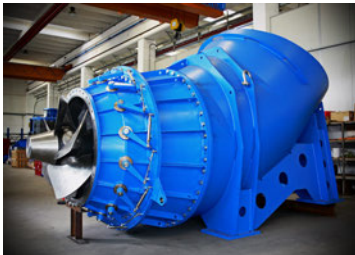
Figuur 2: een Kaplanturbine
