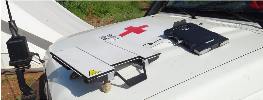
Figuur 24. Een logische toepassing van traditionele satelliet: Draagbare internetverbinding met satellietmodem en antenne, in gebruik bij het Rode Kruis in Zuid-Soedan (2014) (bron: wikipedia.org )
