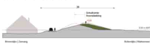
Maatgevend profiel sectie HE-11C ter plaatse van dijkspaal 91+50 Profiel is van toepassing van dijkspaal 89 tot 95
