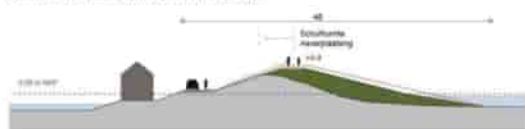
Maatgevend profiel sectie EA-10 ter plaatse van dijkspaal 134+90 Profiel is van toelating van dijkspaal 134+90 tot 141
