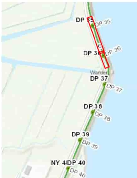
Figuur 4 - Tussenopslag materiaal vlijlaag op de werkbaan thv loswal 6
