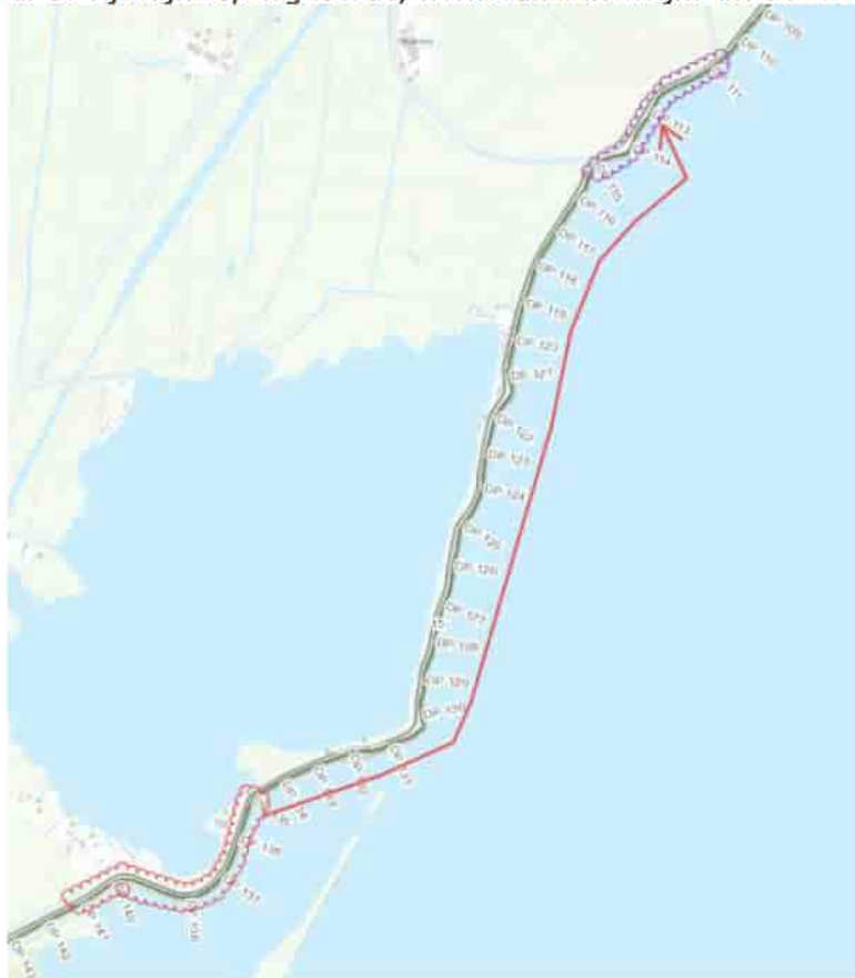
Figuur 3: Tijdelijke opslag locatie, werkbaan buitendijks thv DP111 t/m DP115
