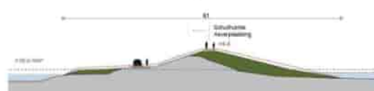
Maatgevend profiel sectie EA-10 ter plaatse van dijkspaal 134+90 Profiel is van toelating van dijkspaal 121+70 tot 134+90
