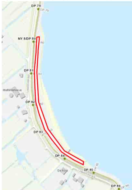
Figuur 5 - Tussenopslag materiaal uit HE-11A op werkbaan HE-11A Eindbestemming grond toepassen onderlaag klei in nieuwe dijk
