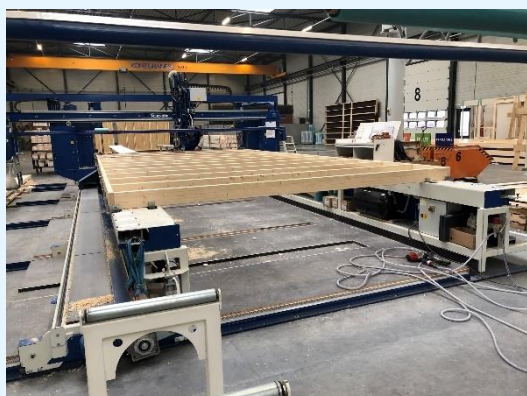
figuur 4: samenstelling frame HSB-gevelement
