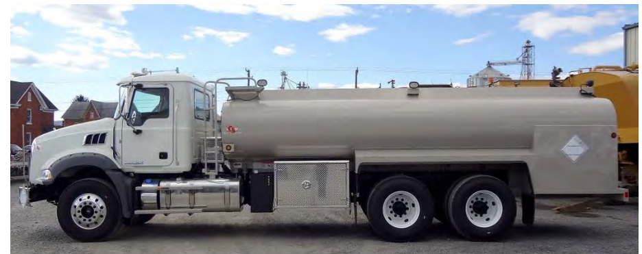
Voorbeeld van een LFO-truck die gebruikt kan worden voor het transport van diesel op Bonaire
